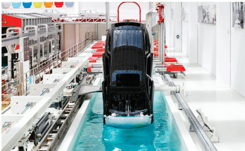
DELMIA controla y proporciona una representación física de cada fase de la fábrica a medida que la carrocería pasa por los diferentes tanques y cabinas de pintura para lograr un acabado perfectamente pintado.
