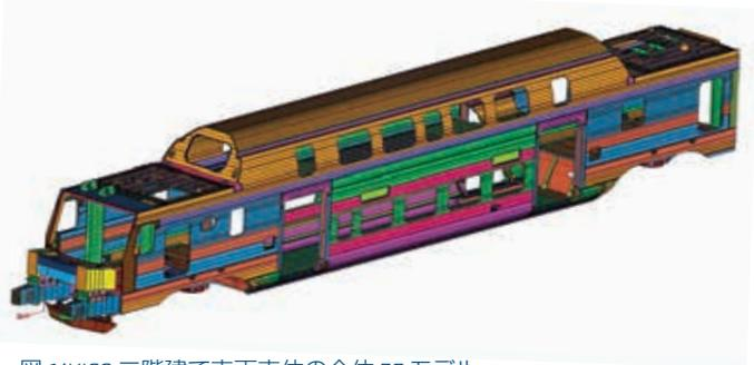
図1: KISS二階建て車両車体の全体FEモデル
