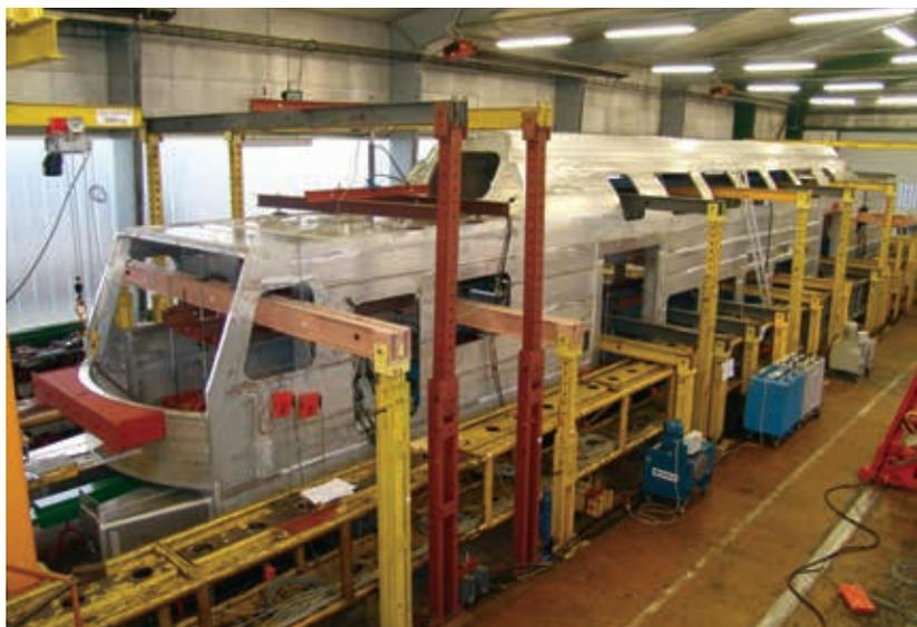
図 4: 静止試験用にセットアップされた実物大の車体
