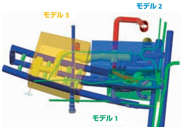
Dr. Sauer and Partners 社の設計エンジニアは BSSU プロジェクトを 3 つの独立したモデルに分割し、この大規模な解析とシミュレーションの作業を効率化した。既存構造物が非常に接近している部分では、モデルの重複が許されている。
