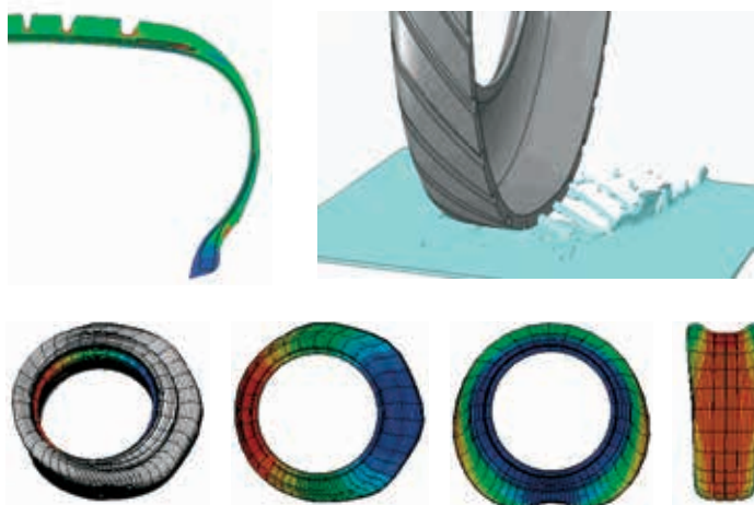
図 1. 初期の研究では、住友ゴムのエンジニアは Abaqus を使用して、転がり抵抗 (左上のタイヤ断面コンター図)、ハイドロプレーニング現象、モード解析 (下 4 図) などのタイヤシミュレーションを実施していました。
