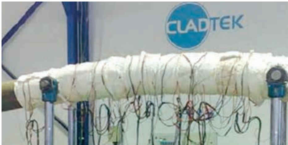
図4. 断熱材が巻かれたCRAライニング管。この試験では、1.5%のひずみ負荷のもとでパイプが加圧され加熱される。
