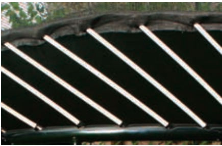
図 2. スプリングフリートランポリンの画期的な支持構造の拡大写真: 白色のロッドが止め具を介して上部跳躍面の柔らかいエッジに結合され、ロッド下端は地面に設置される頑丈な金属フレームに取り付けられる (防護ネットは除かれている)。
