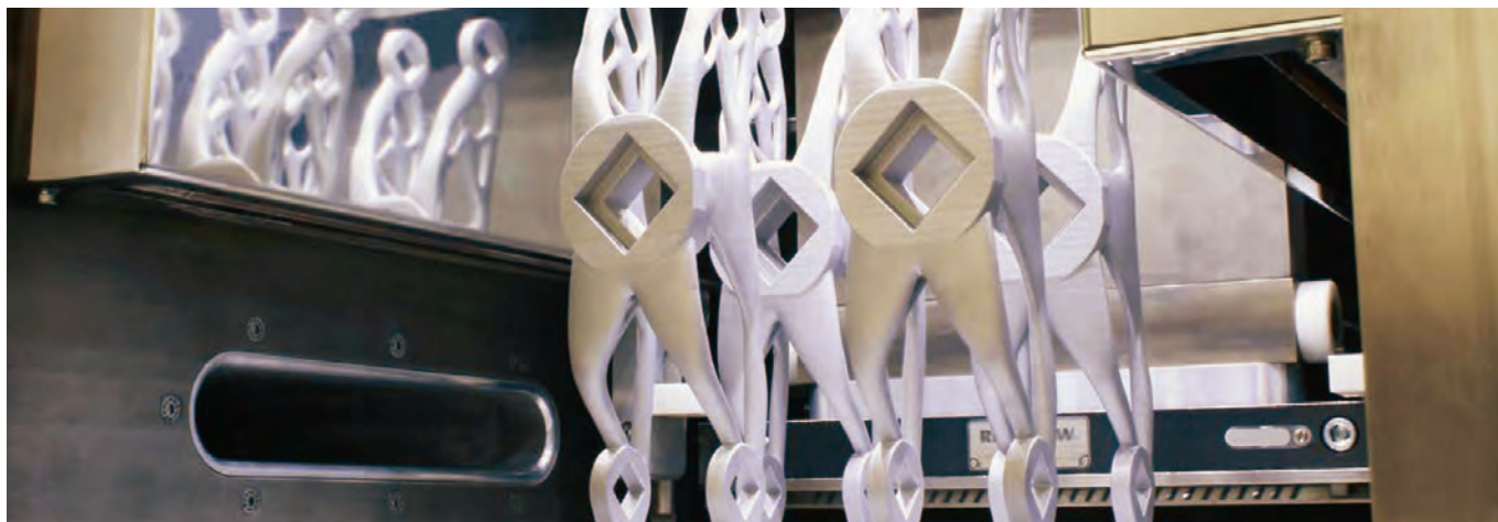
RenAM 500M の造形チャンバー内に置かれた Bleu カーのヒンジ部品
