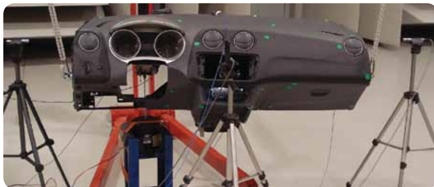
テスト装置での車のダッシュボード
