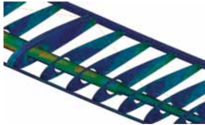
図 4. v-44 アルバトロス号のウィングセルのメインスパーに直接適用された表面力荷重
