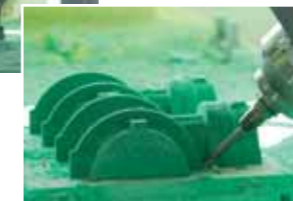
Moderne fünfachsiges Portalfräsmaschine zur Fertigung der Gießereimodelle
