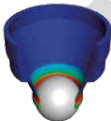
図 2. 押し出し可能ボールシートの FEA
