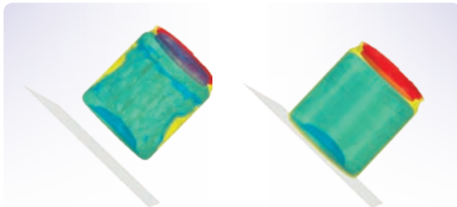
Abaqus FEA による容器落下試験では、連成 Euler-Lagrange 解析が使用され、容器、中身の液体、および接触する表面との間の相互作用が示されている。容器を 3.5 フィート (約 106.7 cm) の高さから硬い床に落下させても、上部はそのままではなければならない。
