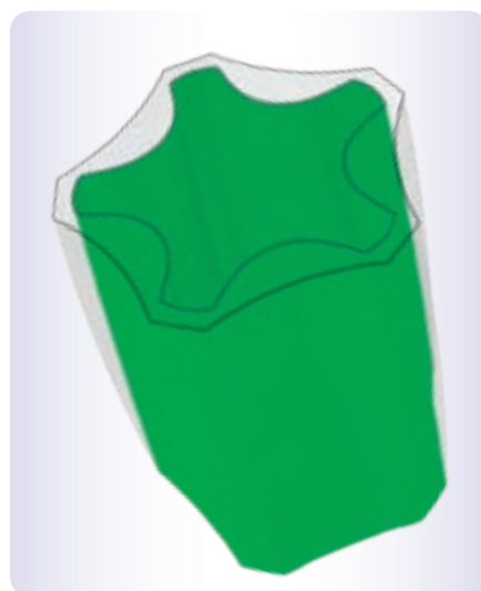
設計された潰れのために PET 容器に設けられている「折り紙」コンセプトの減圧パネル。このパネルにより、冷却時の収縮が補正され、構造的な強度と一体性が維持される。元の形状は透明、最終形状は緑色。
