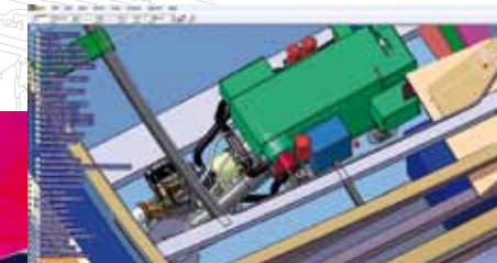
Virtuelle Motoreninstallation bei einer Motoryacht
