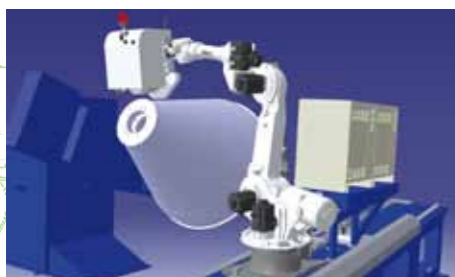
Roboter prüft und schweißt Kegel in Sandwich-Bauweise. Virtuelle Darstellung in DELMIA.
