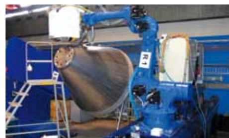
Roboter prüft und schweißt Kegel in Sandwich-Bauweise. Virtuelle Darstellung in DELMIA.
