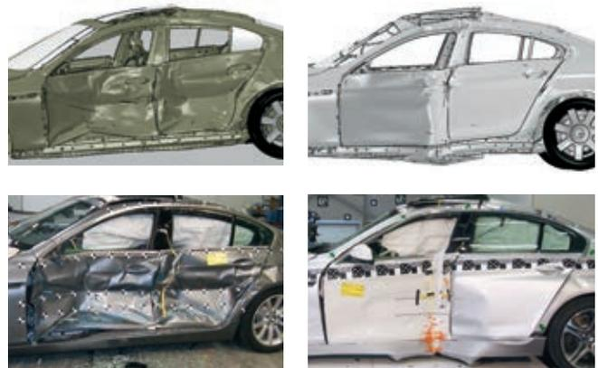
図 3. 側面衝突の荷重ケースは、多くの場合、耐衝突性が最も低いケースとなる。上図は BMW 6 シリーズ「グランクーペ」に対する 2 種類の標準側面衝突試験結果であり、それぞれ、IIHS 可変形移動バリアによる側面衝突試験（左）と、FMVSS 214 ポール側面衝突試験（右）を示している。それぞれに対応する設計シミュレーション結果も示されている。パッシブセーフティ性能が正確に予測されており、試作ゼロの成功につながるものである。
