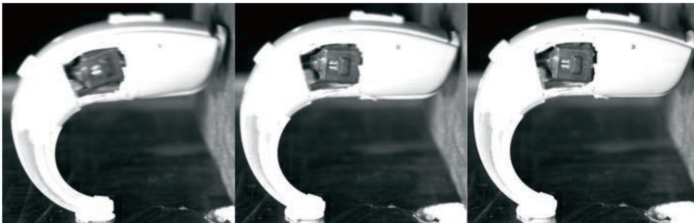
図 4. 高速ビデオ映像を用いた衝撃の記録：衝撃の 0.9 ミリ秒後（左）、衝撃の 0.1 ミリ秒後（中央）、衝撃の瞬間（右）。デバイス中央のレシーバーの動きに注目すること
