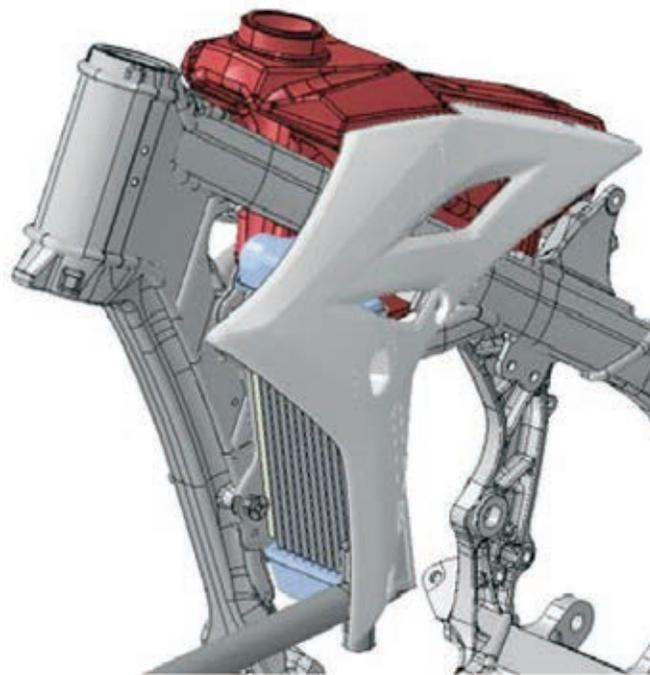
図 3. ラジエータアセンブリの最終設計：プラスチックカバーには、バイク横転時のダメージに対する強度対策がより効果的に施されている
