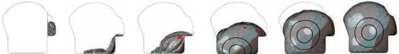
図 3. 膨張式プラグの展開のシミュレーション結果は、実スケール試験の展開と良く一致した
