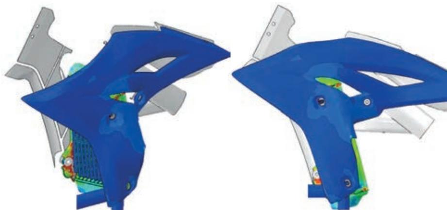
図 2. 一体化されたラジエータアセンブリモデルの解析結果（2 方向の図）
