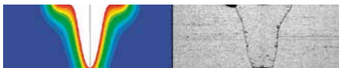
図 1. 通常の溶接シミュレーション: 溶融部のサイズと形状の比較
