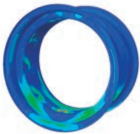
ホイールシェルの最適化解析(左図)。Abaqus で4千回以上の反復と2日間の計算時間を要したが、その大部分はIsightで自動化できた。CRFP製シェルとアルミニウム製センターが取り付けられて完成したリム(右図)
