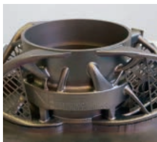
Toscaによるフロントアップライトのトポロジー最適化解析(左図)。3Dプリンティングの事前準備として実施された。3Dプリンターで造形された左リアのアップライト(右図)。サポートの除去前、事後熱処理前の状態。機械加工による最終仕上げも行われていない。最終製品では、重量がわずか1ポンドあまり(545グラム)となった。
