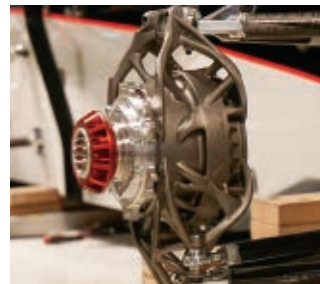
変速機アセンブリの応力分布 (左図)。軸受モデル、予荷重、その他の荷重の影響が示されている。アップライトの内部に組み込まれた変速機 (右図)
