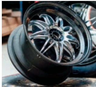
ホイールシェルの最適化解析(左図)。Abaqus で4千回以上の反復と2日間の計算時間を要したが、その大部分はIsightで自動化できた。CRFP製シェルとアルミニウム製センターが取り付けられて完成したリム(右図)
