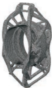
Toscaによるフロントアップライトのトポロジー最適化解析(左図)。3Dプリンティングの事前準備として実施された。3Dプリンターで造形された左リアのアップライト(右図)。サポートの除去前、事後熱処理前の状態。機械加工による最終仕上げも行われていない。最終製品では、重量がわずか1ポンドあまり(545グラム)となった。
