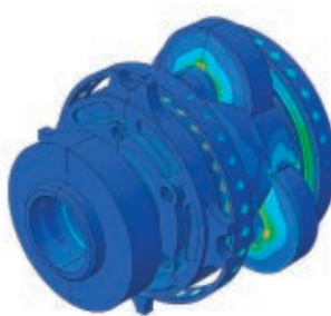
変速機アセンブリの応力分布 (左図)。軸受モデル、予荷重、その他の荷重の影響が示されている。アップライトの内部に組み込まれた変速機 (右図)
