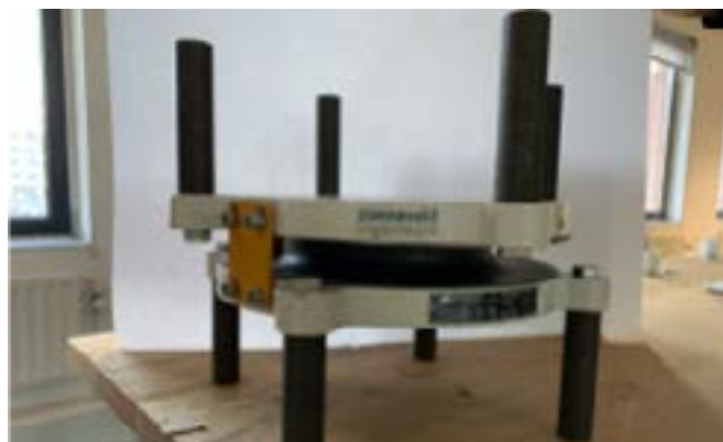
Zonneveld Ingenieurs社が設計したダブル・カーブ・スライダー。縦方向の振動を吸収すると同時に建物の1階で生じる騒音を軽減するために、スライダーの上に配置されたドーナツのような形状のCDM装置が役立てられています。
